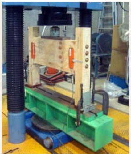
240mmの梁に対して荷重をかけた場合、在来工法に比べてJWOOD工法の接合部は約1.5倍の耐力を示しています。写真は、JWOOD工法接合部(梁せい330mm)のせん断試験の様子。
